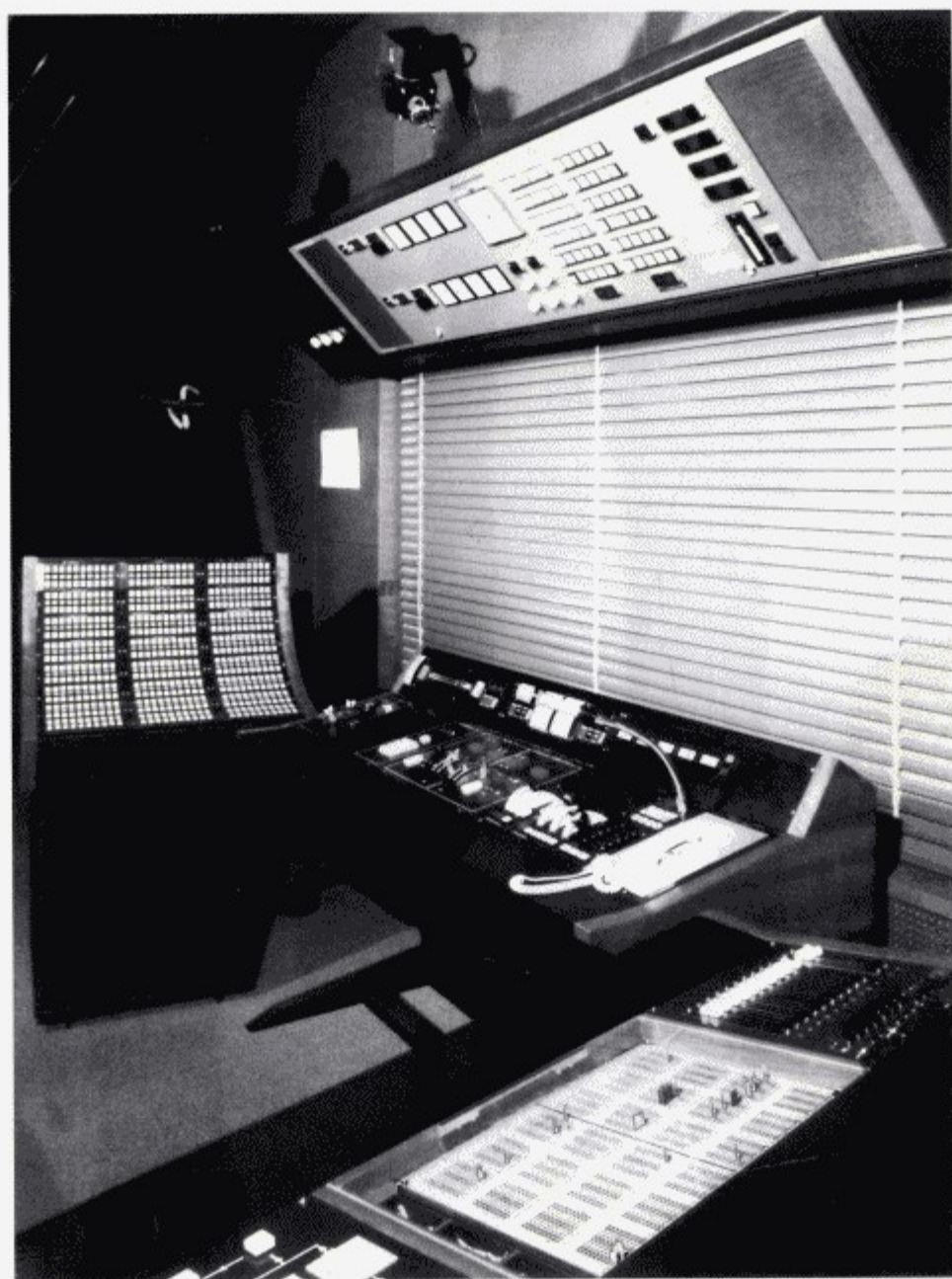
图402 安装有DDM系统的灯光控制室 左：单控操作台 中：控制台 右：用于紧急情况的插针矩阵板 上：显示板 and 特殊控制器
