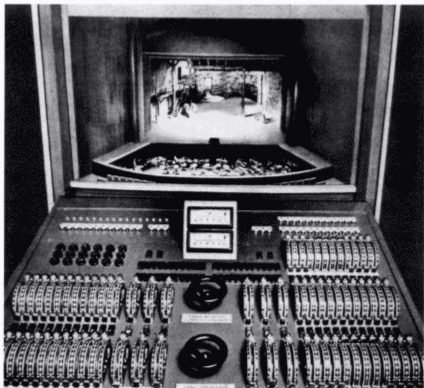
图392 带预选和场景转换轮的电子闸流管调光器的控制台，1955年。
