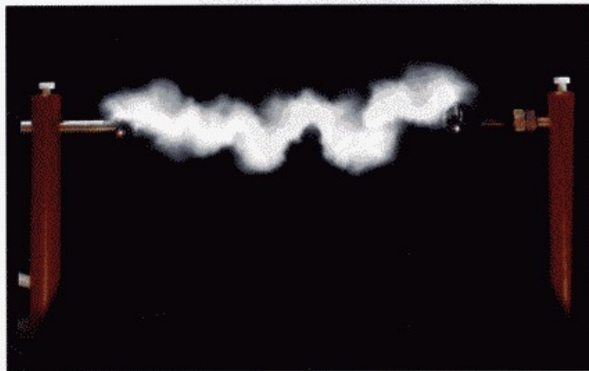
图6 实验室模拟闪电。40kV的瞬间放电，长30cm。
