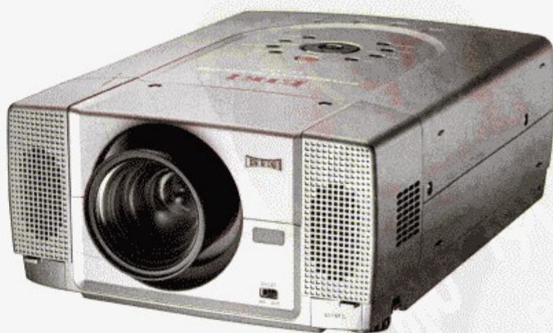
图366 EIKI视频投影。光亮度：5500 ANSI流明；解析度：XGA (1024×768)；对比度：1000:1；输入：DVI-D (with HDCP)，15-针D sub，RGBHV，Y/Cb/Cr，Y/C，FBAS；噪声：36分贝 (ECO mode)
