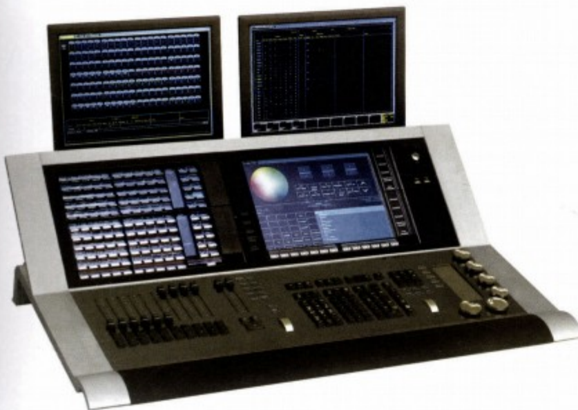
图381 EOS——ETC生产的混合灯光控制台。多达5000个通道，一对专用的重演推杆，10个用户可定义的电动集控杆，可翻30页，2台15英寸LCD触摸屏，ETCNet2、Net3/ACN、RDM协议，MIDI和SMPTE接口。
