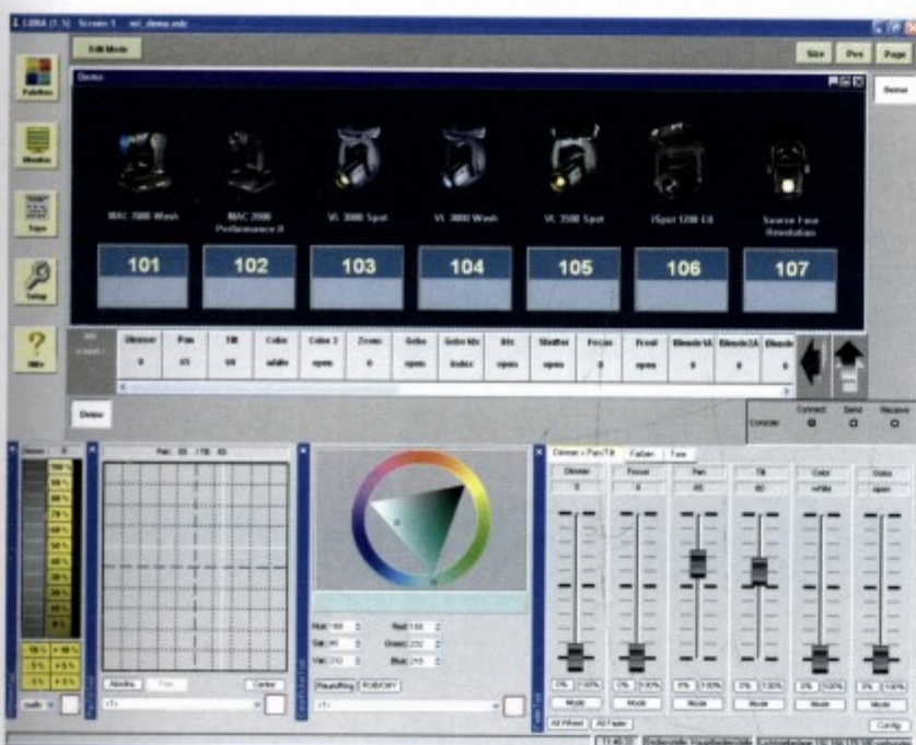
图380 Libra图形用户界面的截图。Transtech NT(X)将Libra软件完整地集成在一起。它的可更改的用户界面可以自由、方便地进行设备选择和参数处理。上边图像中显示的是不同的设备选项，中间是颜色选择，右边是各式推杆，用来设置参数，比如挡光板。Libra使用触摸屏，使它的操作快速而有效。
