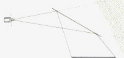
图357 如果幻灯机和投影区域的距离不能以最短线路直接投影，那就会产生偏差，这时可以用反光镜来偏转投影。
