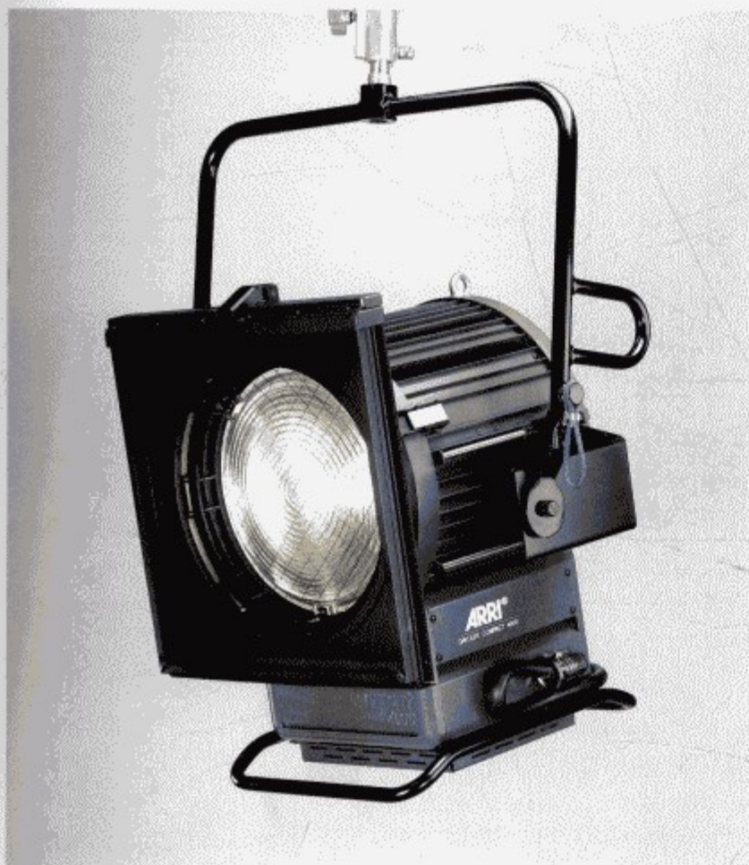
图238 4000 W 日光型聚光灯，透镜直径30cm，戏剧舞台用，带换色器安装盒，重心调节装置，单端放电泡。
