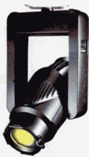
图26.5c VARI-LITE VL1000 泛光型摇头电脑灯 变焦镜头, 机械光闸, 混色系统; 蓝色~琥珀色~品红色, 对流冷却系统, 375W日光型光源或1000 W钨钨灯, 高端设备
