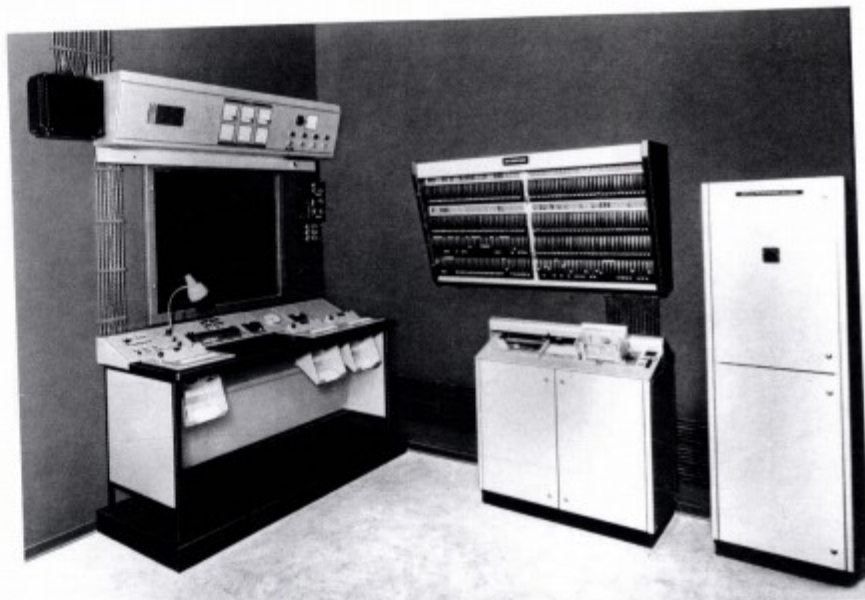
图395 带穿孔卡输入和备份系统的灯光控制台，1960年。
