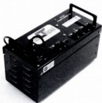
图289 移动DMX信号分配器，控制自动灯弓、换色器、机械调光器等等，并为这些设备提供电力。
