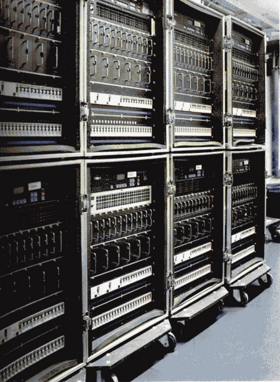
图373 IES正弦波调光器改变电源正弦波的幅值, 低噪声, 无干扰谐波, 有工作状态报告和自动短路保护。
