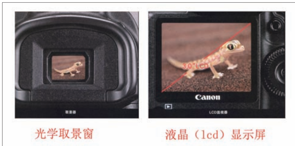
▲ 图1-21 光学取景窗与液晶显示屏
