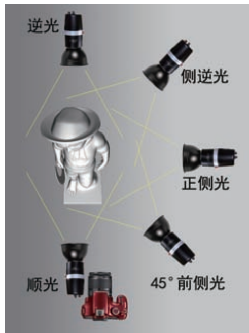
▲ 图2-9 拍摄方向示意图
