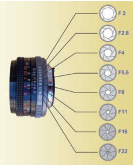
▲ 图2-12 光圈示意图
