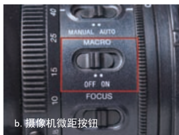
▲ 图3-39 微距模式和微距镜头
