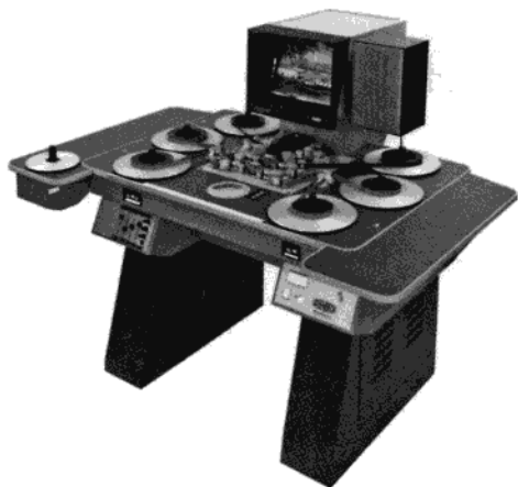
图 1-14 平台式的剪接设备（最上方的圆金属盘放置胶片，可放出画面；其他则是声音使用）。
