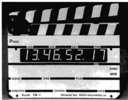
图 3-14 这个拍板包含有电子显示的时间码和拍击器。
