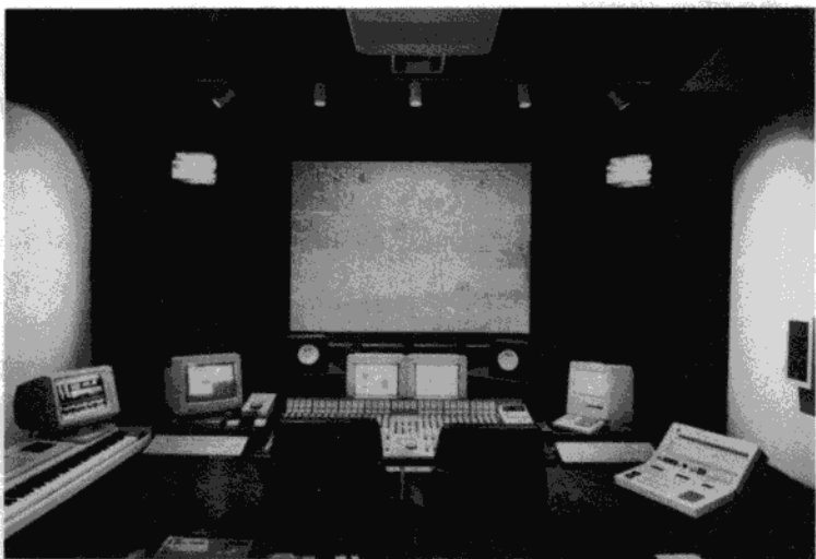
图 13-10 声音和图像在这样的设备上结合。图像被投影到大屏幕上,几个人操纵声音控制,来适当混合不同的声源。
