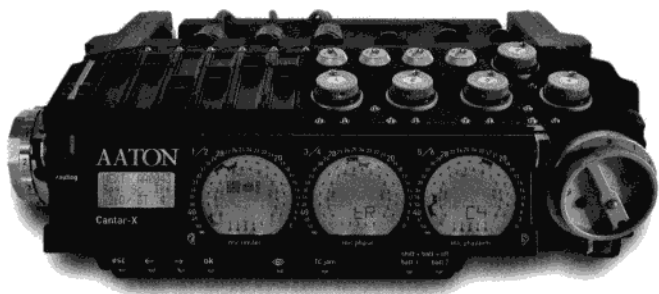
图 7-15 (a) 是能将声音录在硬盘上的纳格拉录音机;(b)Cantar-X 录音机,它可以将声音同时录在内置和外置硬盘上,这款 Cantar-X 还有一个内置的 DVD 刻录机和一个火线插头,可以用来在机器外刻录 CD 或 DVD。
