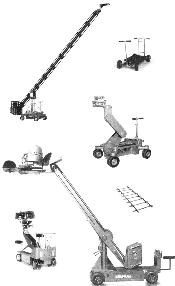
图 5.4 多种多样的移动摄影车和吊杆（图片由查普曼－伦纳德有限公司、J.L. 费舍尔有限公司、马修斯播控设备提供）。
