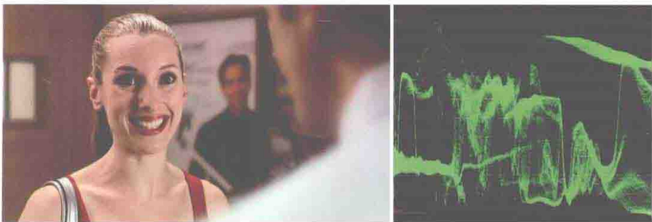
图 3.63 使用亮度曲线拉伸中间调反差之后的结果
