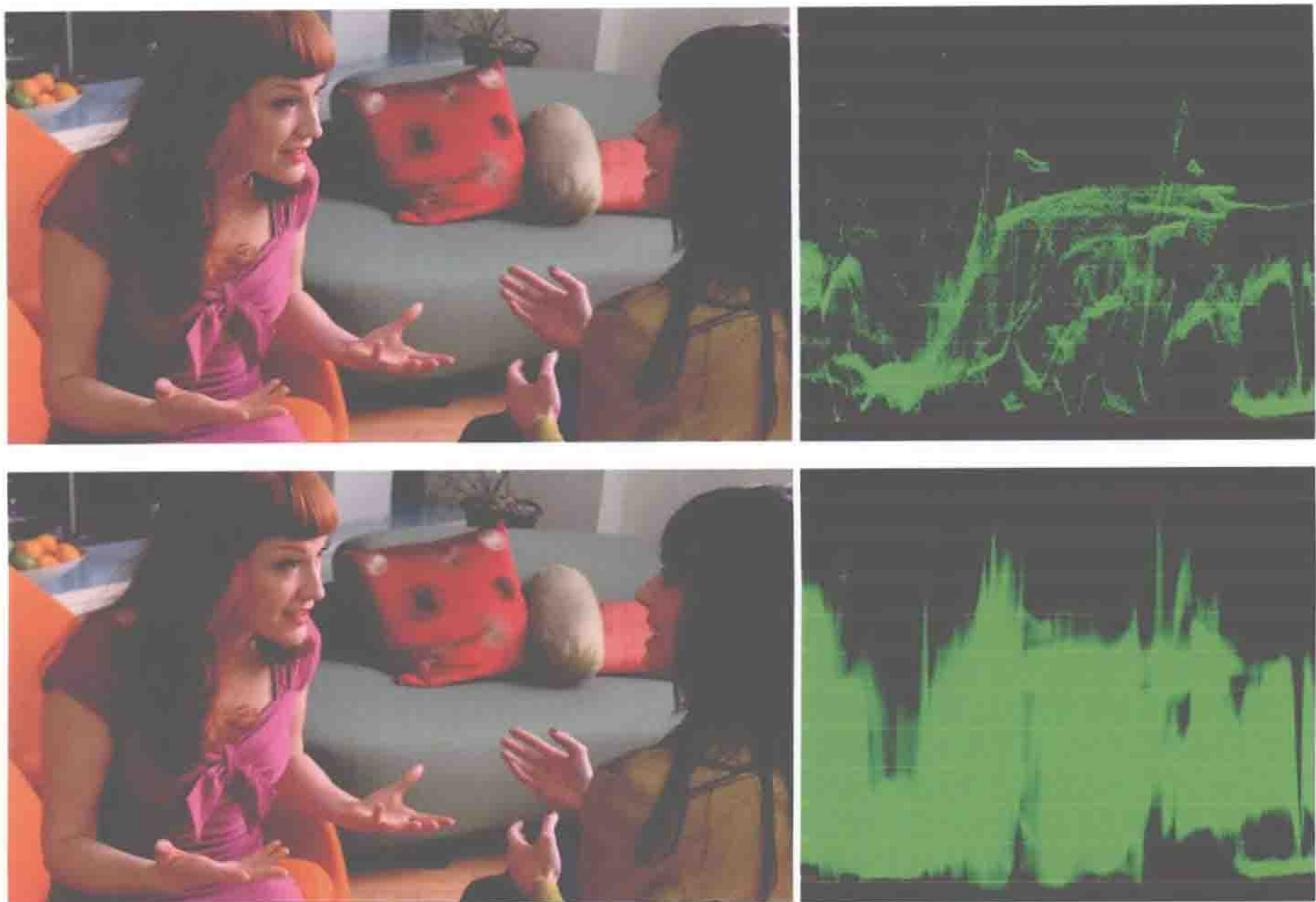
图 10.12 上图，波形监视器设置为 LP (LOW PASS)，只显示亮度。下图，相同的图像，波形监视器在 FLAT (FLT) 模式下，亮度和色度信号都显示
