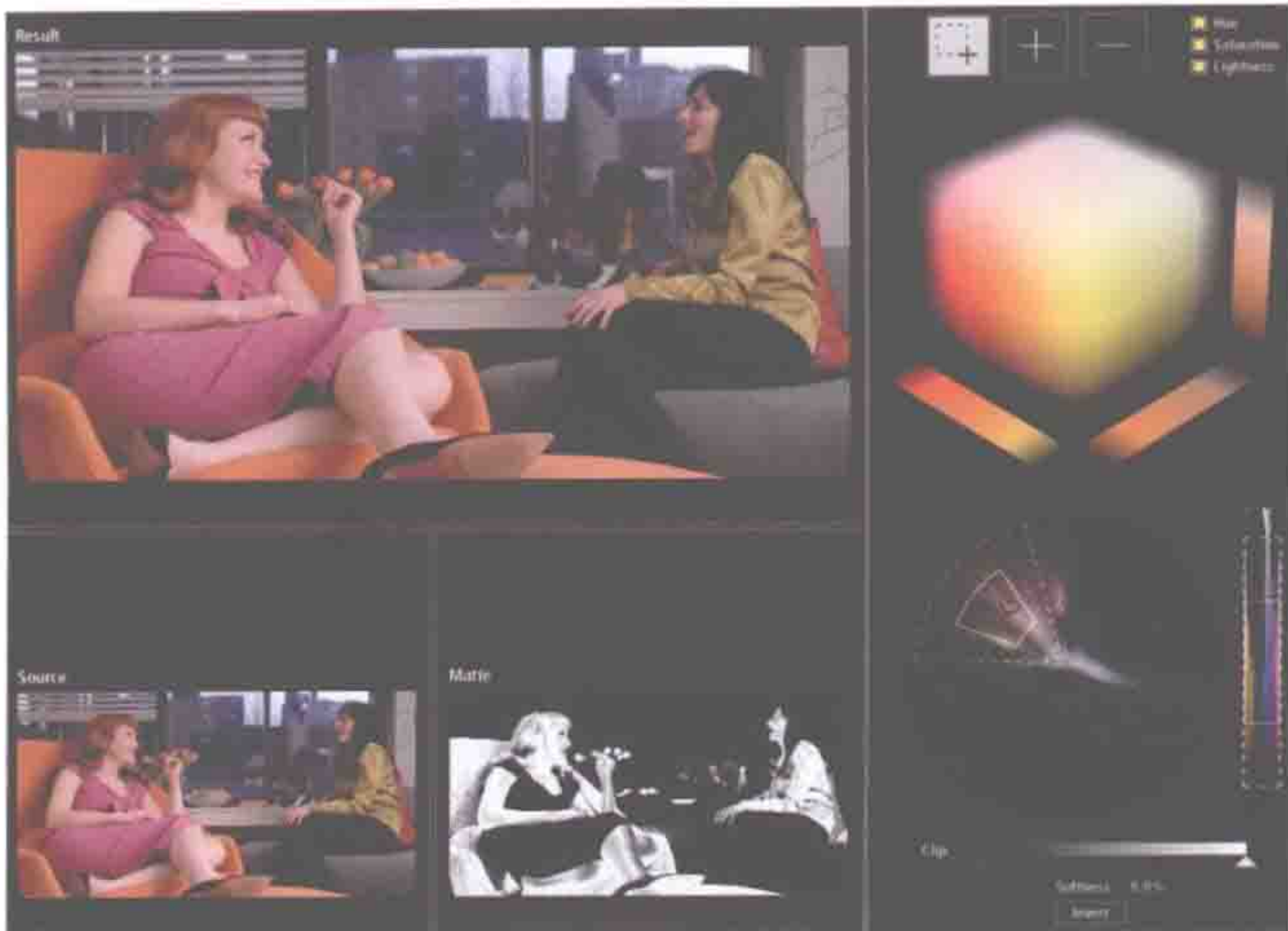
图 5.4 Magic Bullet Colorista II 的键控器，它对传统的 HSL 键控界面进行分离，将键控的操作界面变得更加平易近人，更易用
