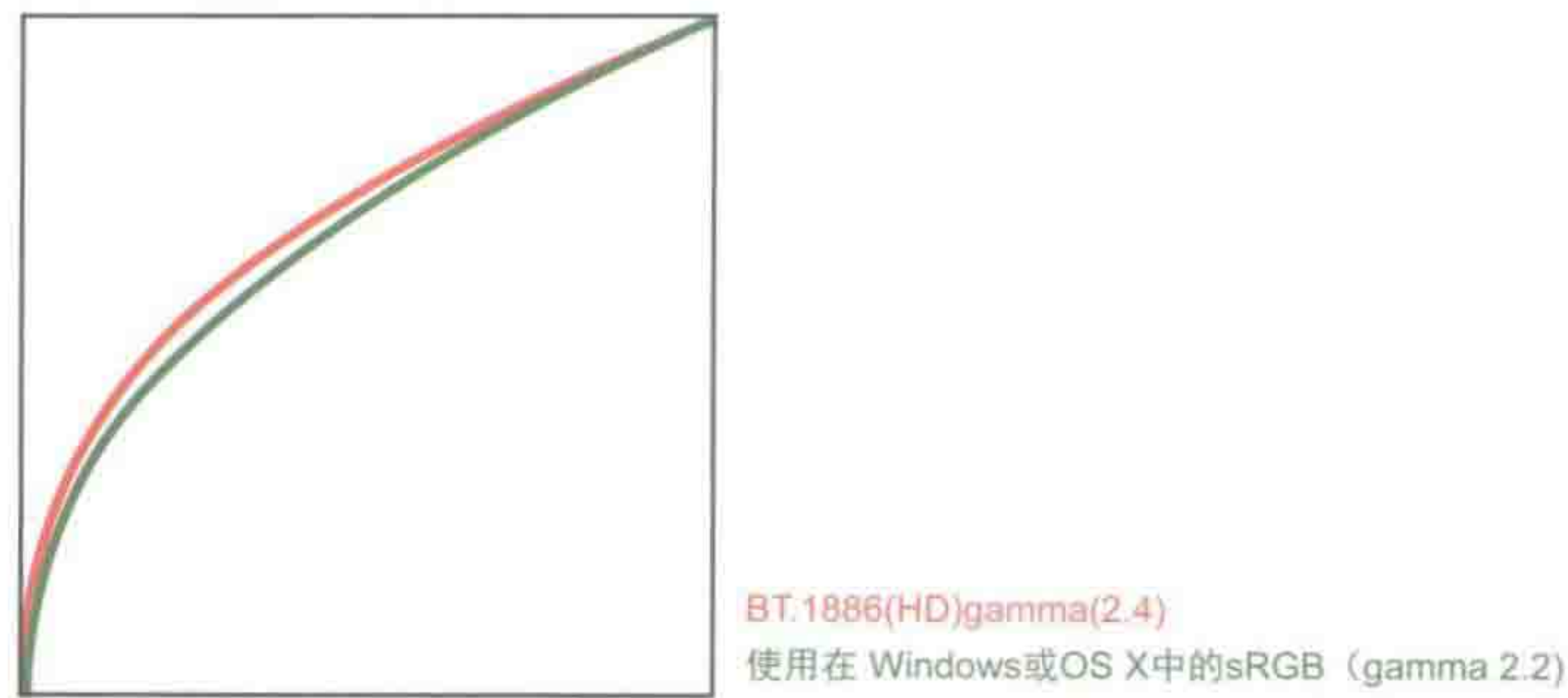
图 3.7 对比 BT.1886 gamma 与计算机显示使用的 gamma
