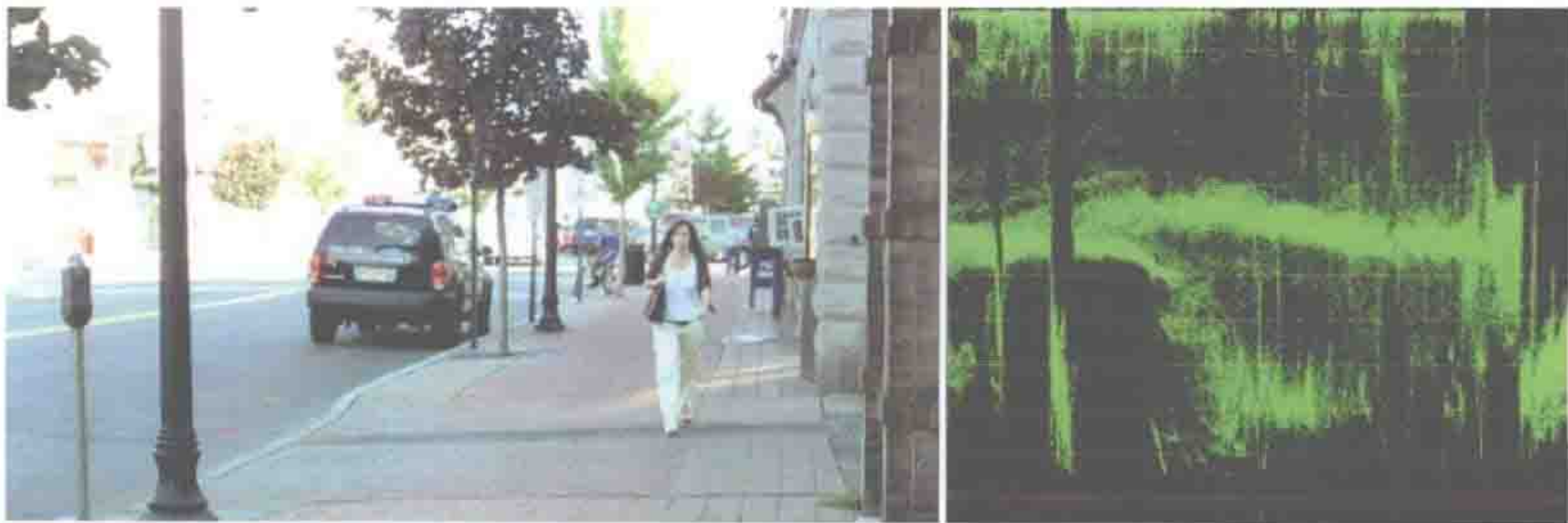
图 3.117 高光部分严重过曝的图像
