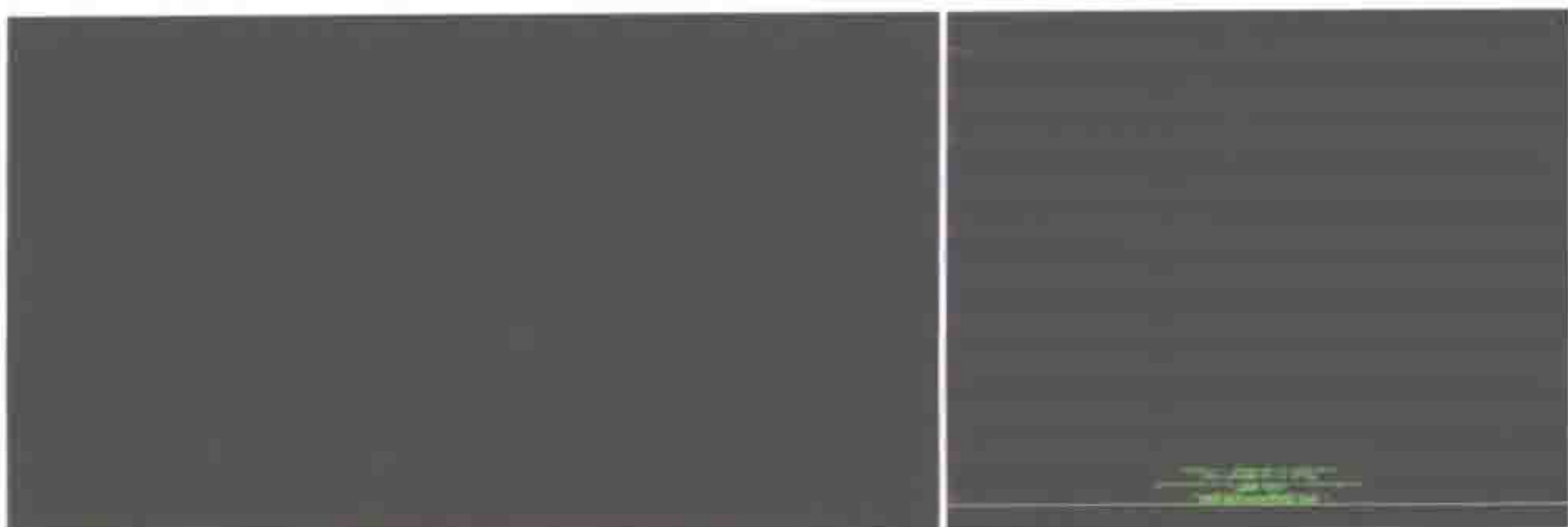
图 3.87 降低测试图像的暗部，压掉黑位。最暗的字已经与周围的黑融在一起了
