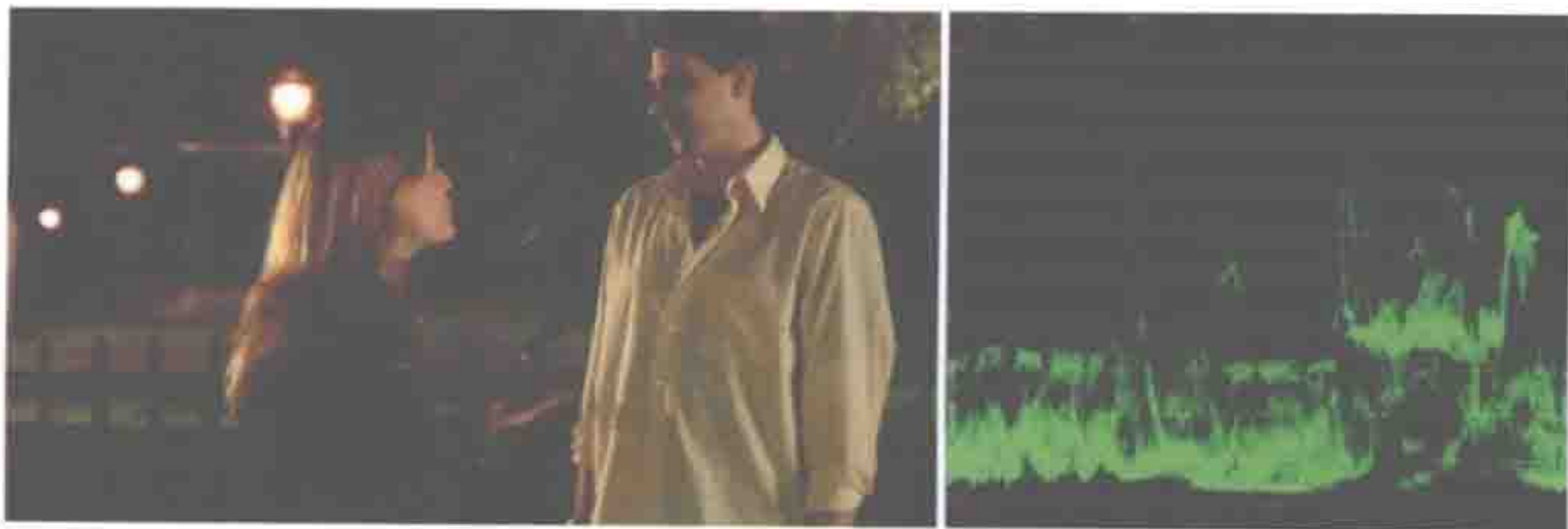
图 3.77 原始画面。注意街灯的位置，导致高光峰值大于 100%（IRE），我们需要将它信号合法化
