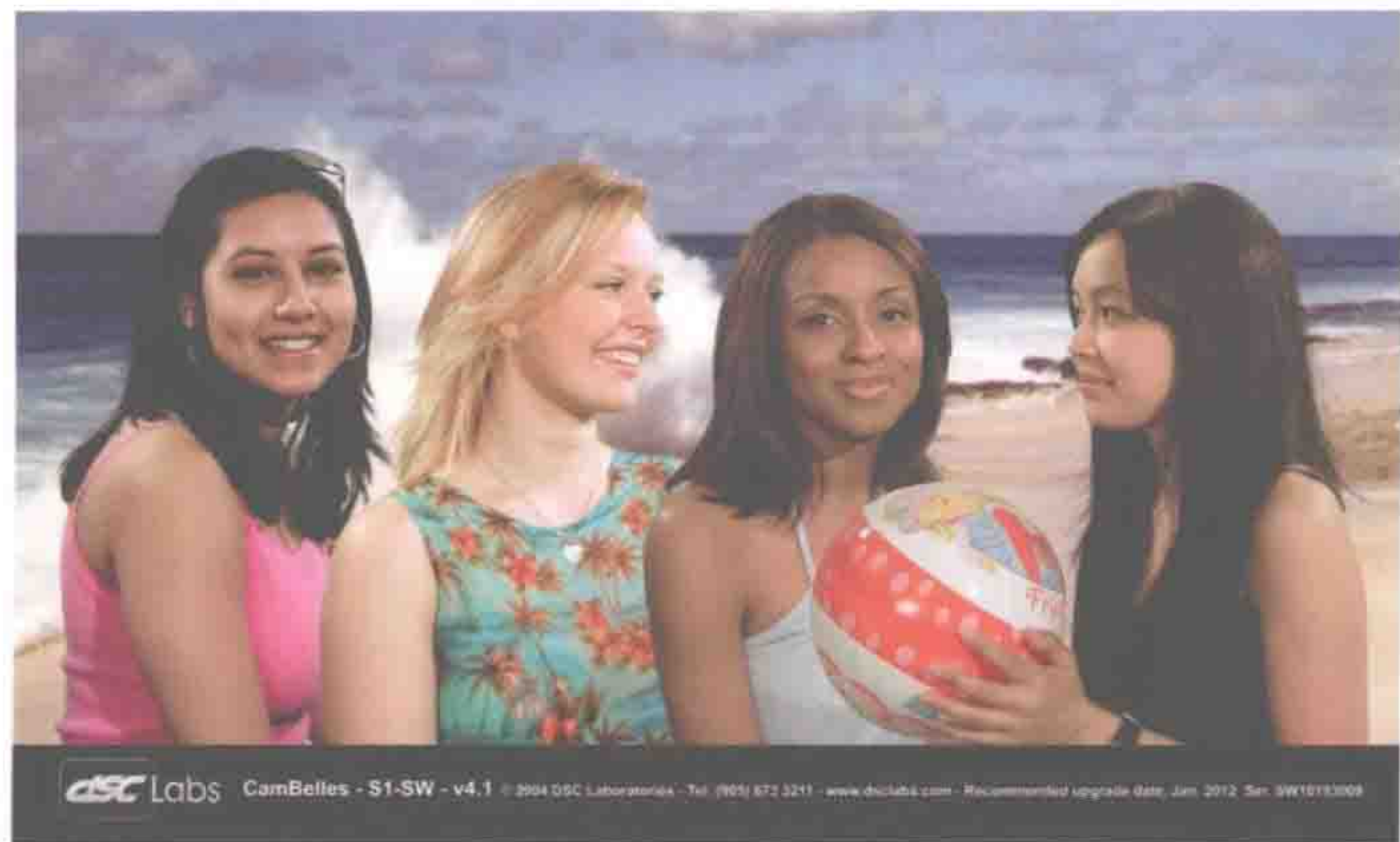
图 8.13 DSC Labs 的 CamBelles 夏季测试图（CamBelles Summer test chart），旨在为对调整匹配后的摄像机提供详细评估参考。肤色与如图 8.10 中所示肤色块匹配
