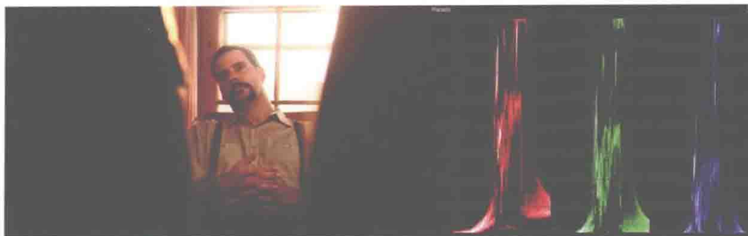
图 10.27 高对比度的调色把图像细节的边缘（波形两端）裁切了
