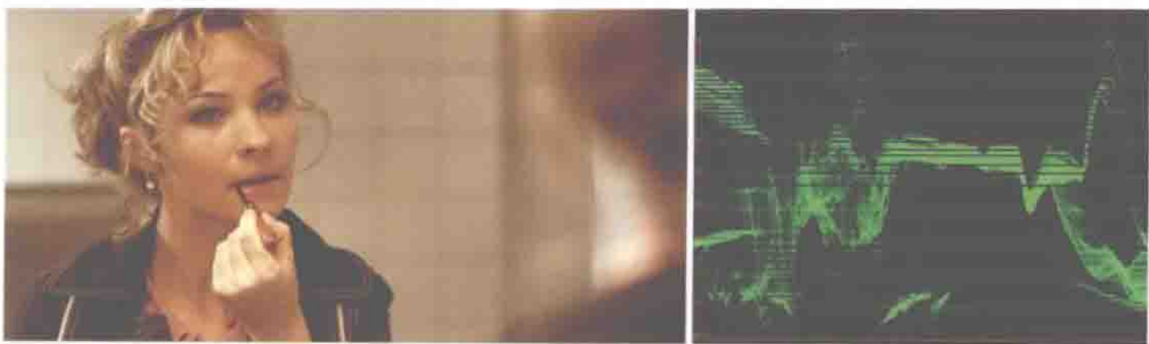
图 3.89 通过降低中间调来压暗画面，而不是降低黑点造成不正常的暗部
