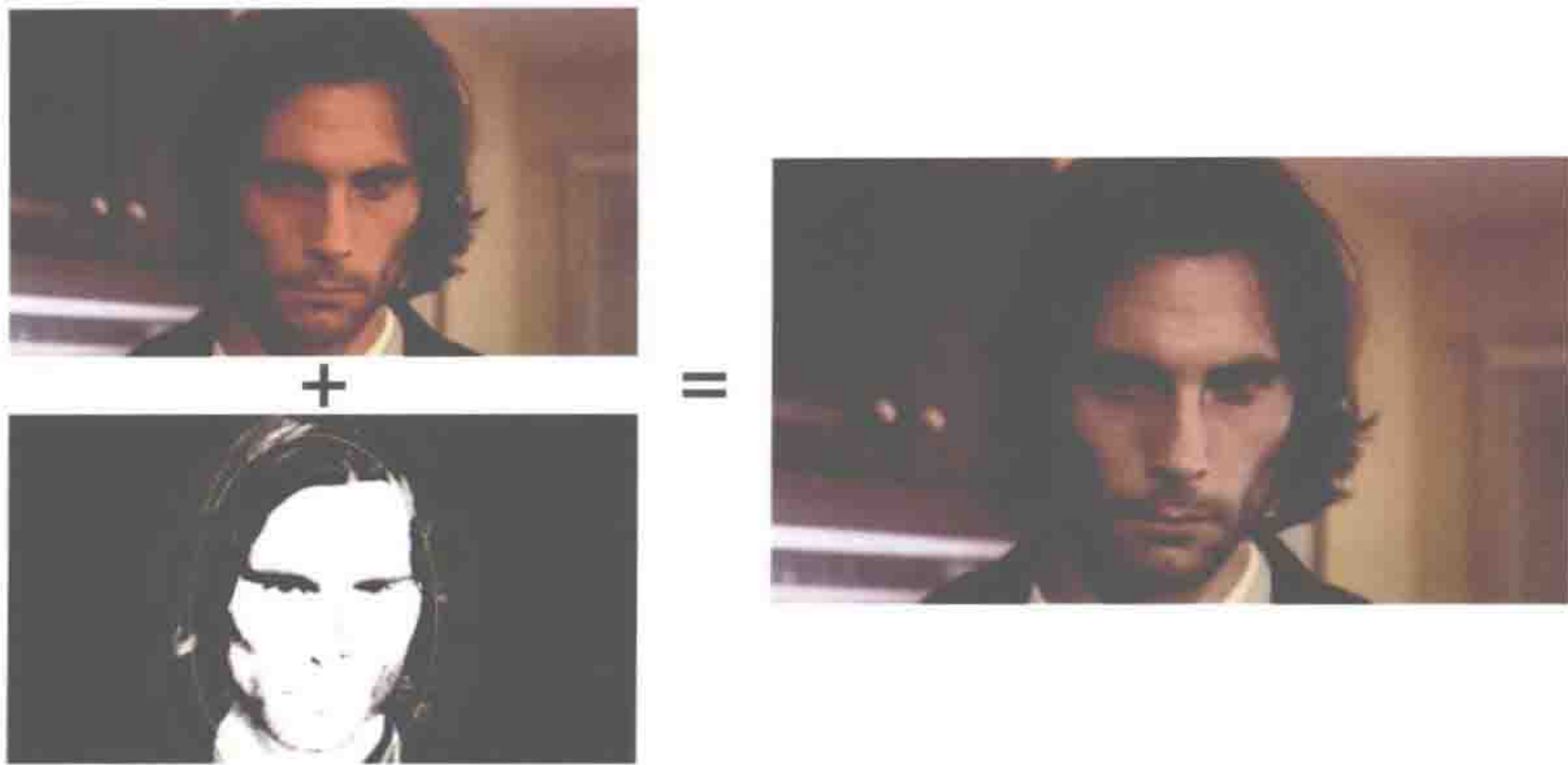
图 8.76 用一个遮罩或 Power Window 限制 HSL 选色范围
