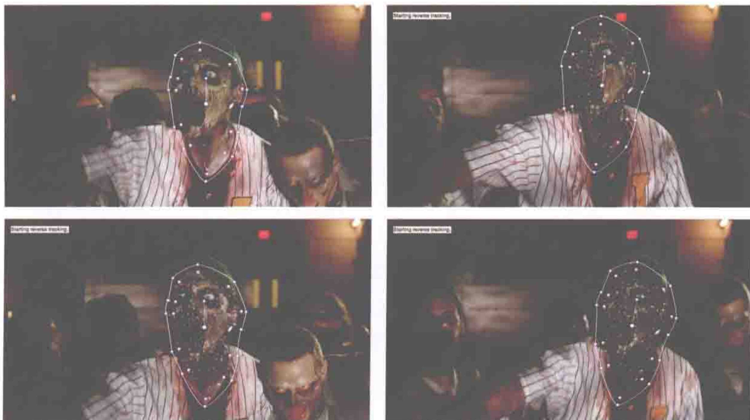
图 6.39 上面两张图是达芬奇 Resolve 的跟踪控制（我们可以看到遮罩和控制点），接着下面的图是正在进行跟踪。基于自定义形状及其跟踪点来自动跟踪
