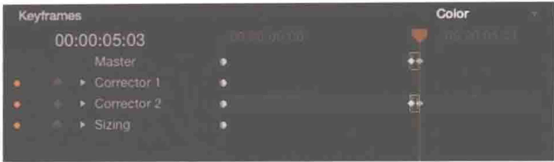
图 7.23 关键帧曝光变化发生的范围，即素材出现变化之前的一帧和颜色变化后的一帧的范围
