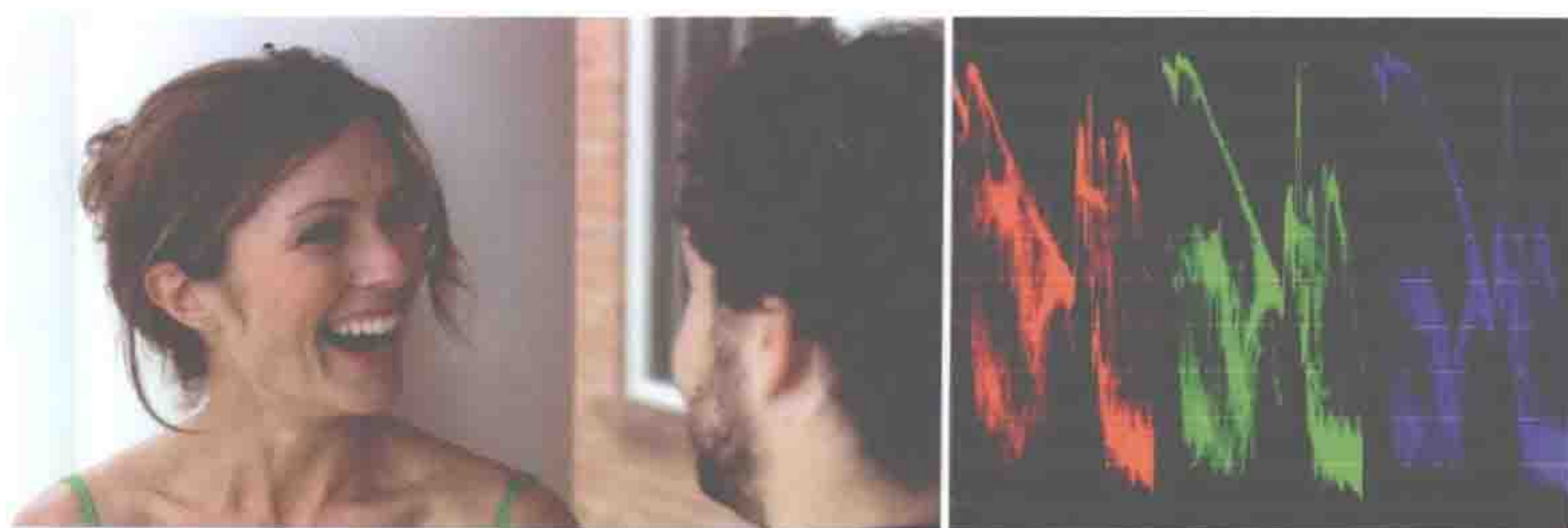
图 4.13 红色波形通常是最强的，蓝色波形是最弱的，波形顶部和底部接近对齐一致，这让我们知道高光和暗部是相当中性的
