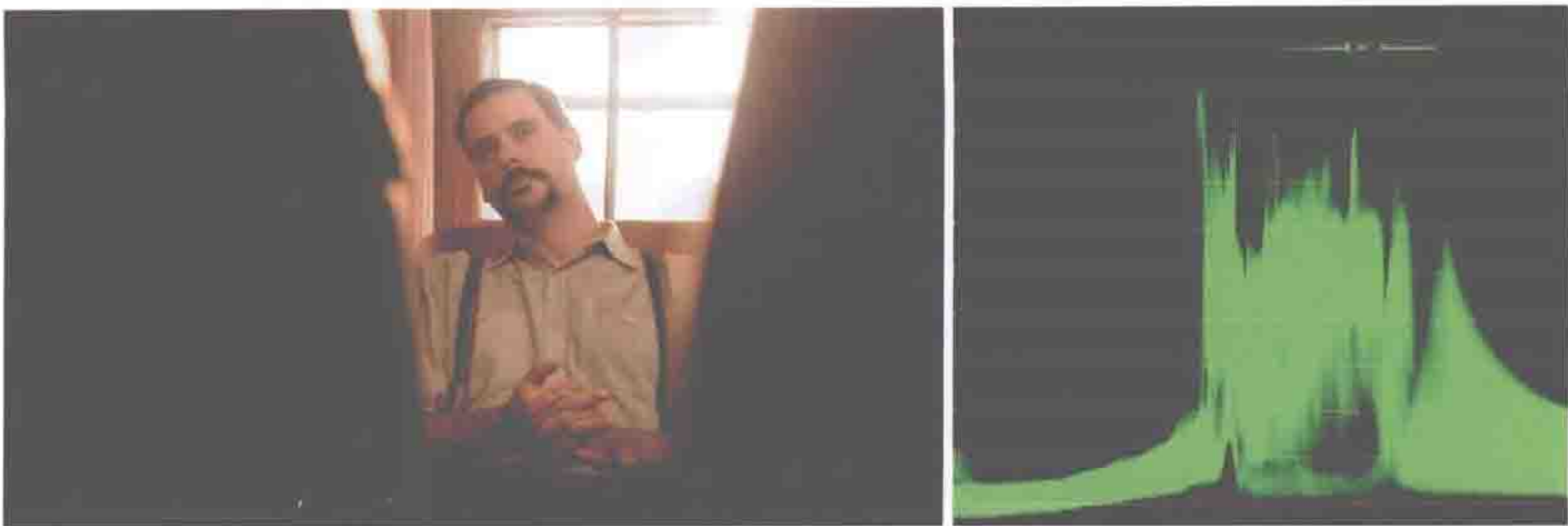
图 10.22 降低窗户高光的饱和度，合法化信号
