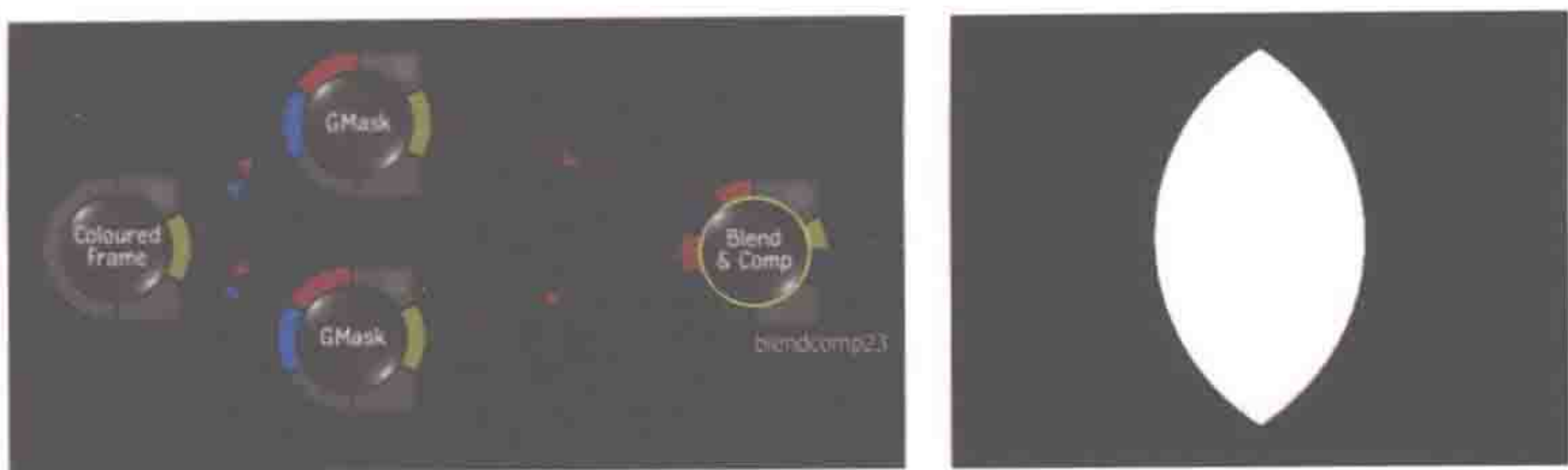
图 5.55 使用 Darken（变暗）混合模式组合形状遮罩
