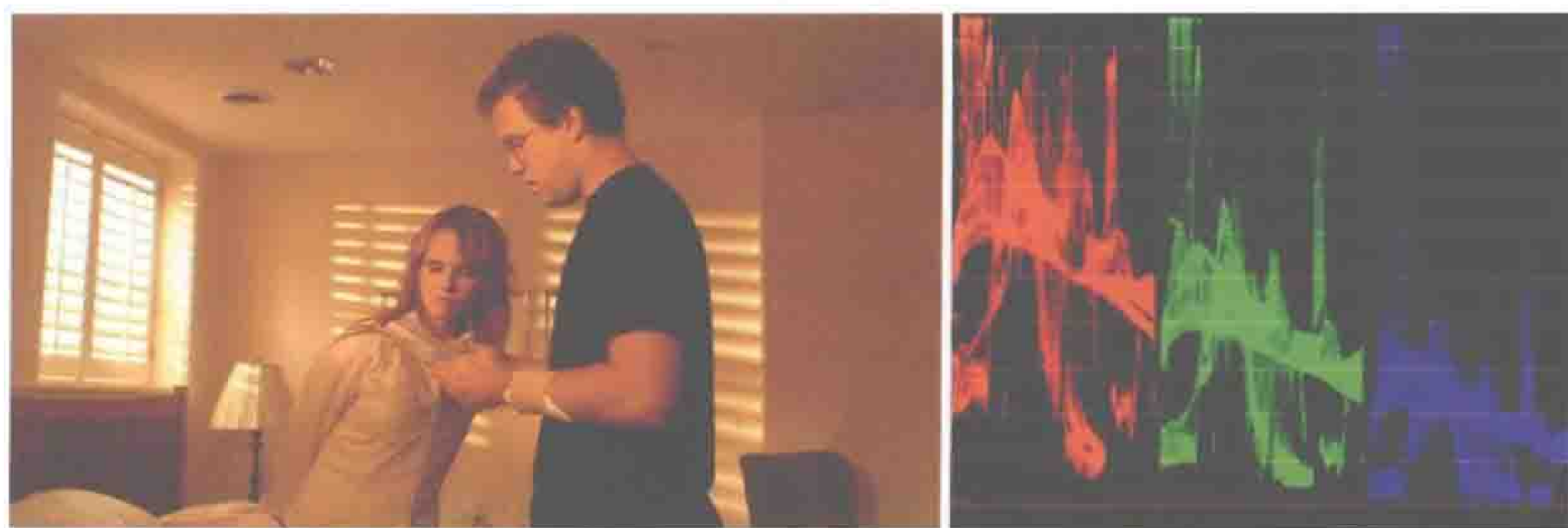
图 4.105 左侧为没有调整过的原始画面。分量示波显示红色通道过高，而蓝色通道过低
