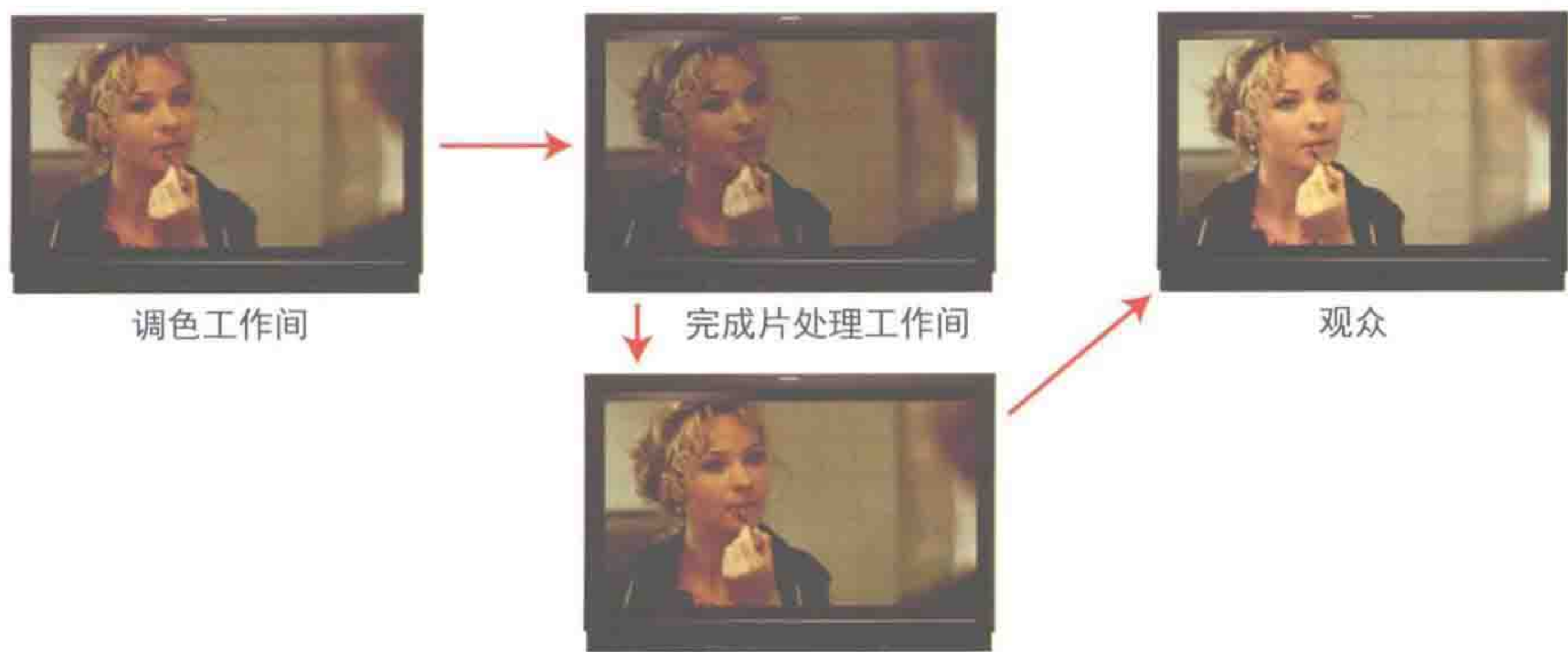
图 2.2 在完成片环节的工作间所使用的监视器未经校准（过暗），因此，我们会对图像做出调整以“修正”图像（调亮）。但结果是最终交付的图像比调色师预期的要亮
