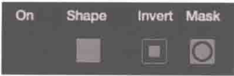
图 6.12 达芬奇 Resolve 的布尔运算选项，能让你决定两个形状之间是融合关系，还是相减关系（一个形状中减去另一个形状），也称遮罩的减法或加法模式
