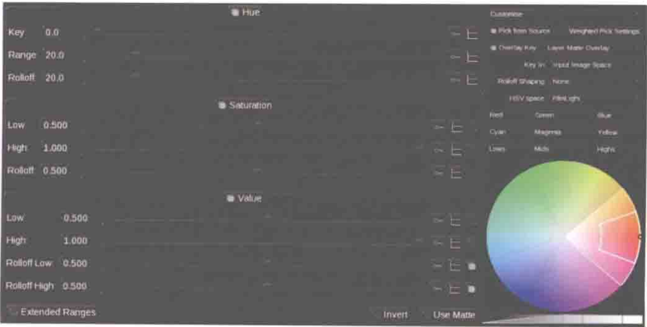
图 5.3 FilmLight Baselight 调色系统的 Hue Angle keyer 键控界面。它本质上是一个 HSL 键控，而且它集成了色相和饱和度控制，还能自定义键控
