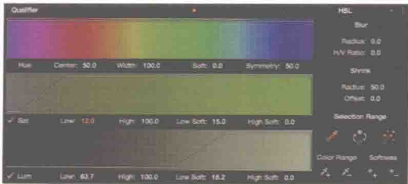
图 10.9 左图，是达芬奇 Resolve 的选区设置，用于隔离最亮和最饱和的像素点。 右图是键控蒙版，降低选区的饱和度使目标物体合法化，不影响画面的其他部分
