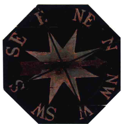
▲ 罗经盘 这个罗经盘与屋顶上的风向标相连，方便杰斐逊从室内观测风向。
