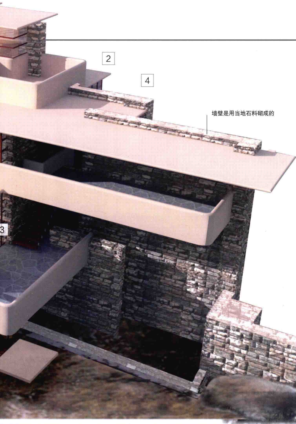
▲ 流水别墅 赖特绘制的这幅透视图采用的是从瀑布下方仰视建筑的角度，因此放大了阳台的尺寸和悬臂结构。
